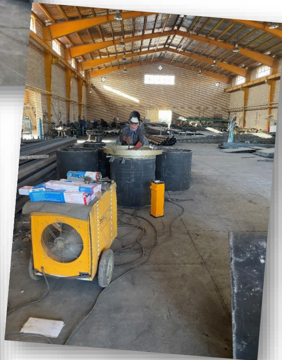
تصویر ۲۸ جوشکاری و ساخت اسپول
