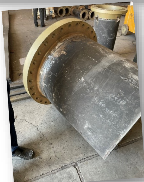
تصویر ۲۸ جوشکاری و ساخت اسپول
